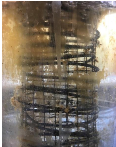
Bild 61 Fotoaufnahme des Ref-R am 24.10.2019 mit erkennbar geringem Biofilmaufwuchs auf dem Trägermaterial (Silikonschlauch)
