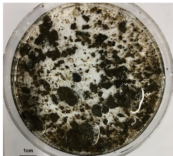
Bild 71 Fotoaufnahme des granularen Schlammes aus dem SBR
